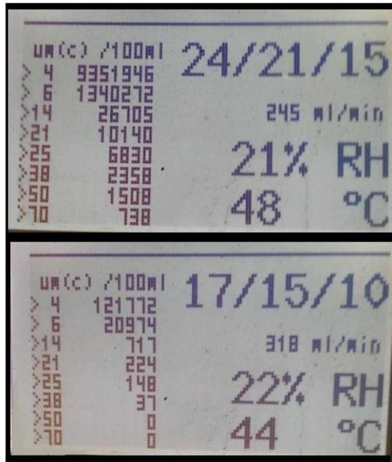
Результаты фильтрации масла в колесных моторах
