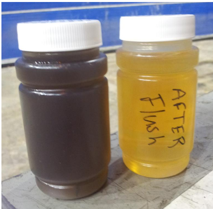
Результаты фильтрации масла в колесных моторах
