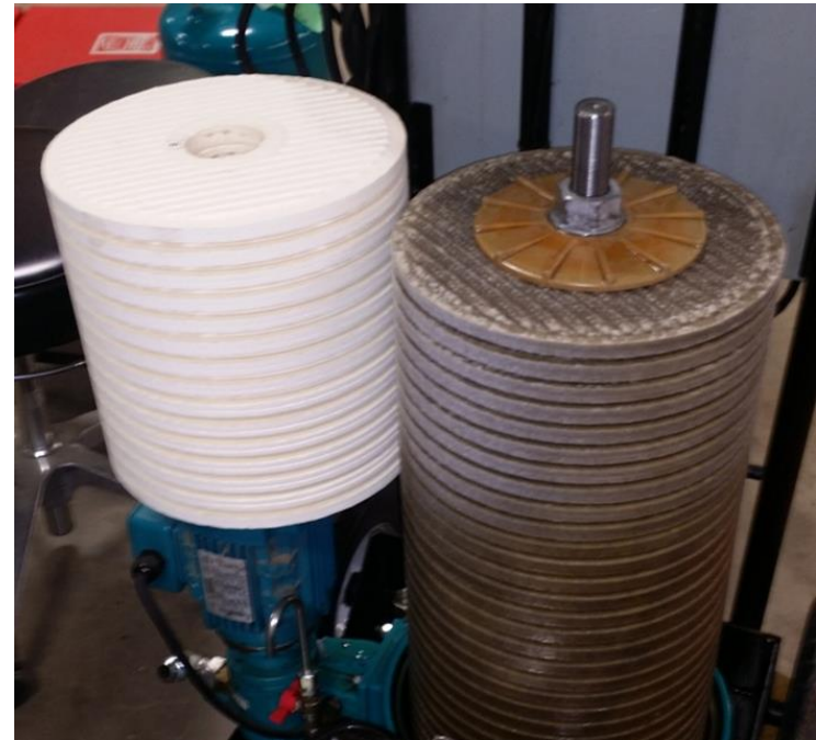
Фильтрация нового моторного масла
