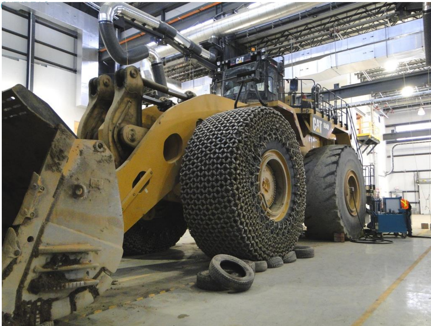
Промывка дифференциала колесного погрузчика CAT 994
